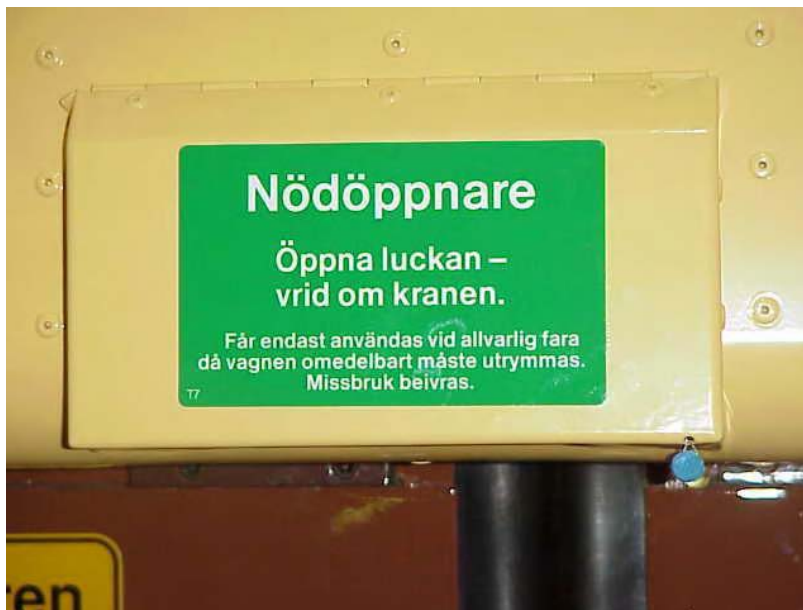
Figur 3. Bild av lucka under vilken nödöppnaren till dörren finns.
