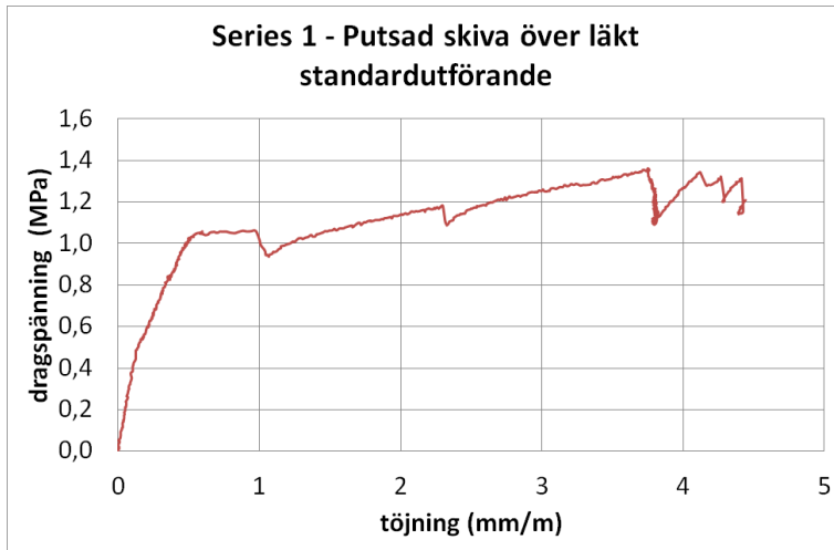
Figur 5.2.3 Spännings-töjningskurva för putsad skiva
