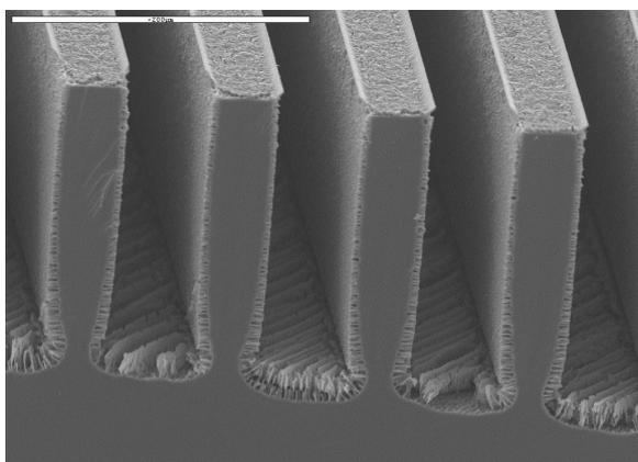
*Figur 1. Här visas strukturen på en typ av mikrochip som använts i det här arbetet. Det består av 42 parallella kanaler, 235  $\mu\text{m}$  djupa och 25  $\mu\text{m}$  breda. Kanalerna mynnar i var ände i en bassäng. På mikrochipens yta immobiliserades (d.v.s. bands fast) enzym eller antikroppar. Reagens och prov tillsattes i ett vätskeflöde som kontinuerligt pumpades genom chipet, vanligen 10 till 50  $\mu\text{l}/\text{min}$  (1  $\mu\text{l}$  är 0,000001 liter).*
