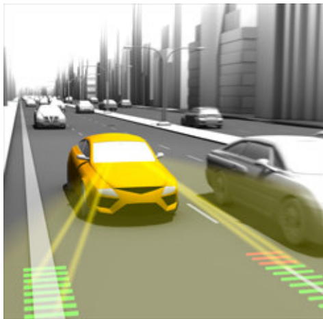
Figur 9. Sensorer för körfältstöd håller koll på körfältsmarkeringarna Källa: Continental Automotive, http://www.conti-online.com .
