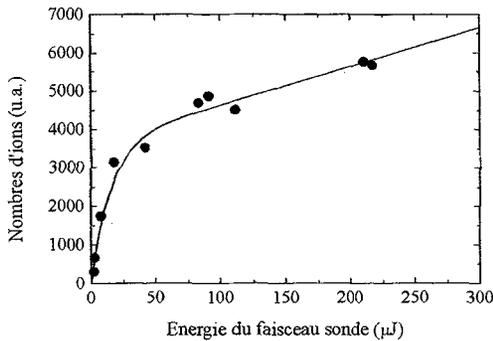
**Figure 1** : Saturation de l'ionisation de l'état excité  $1s2p \ ^1P$  à la longueur d'onde sonde de 355 nm.
