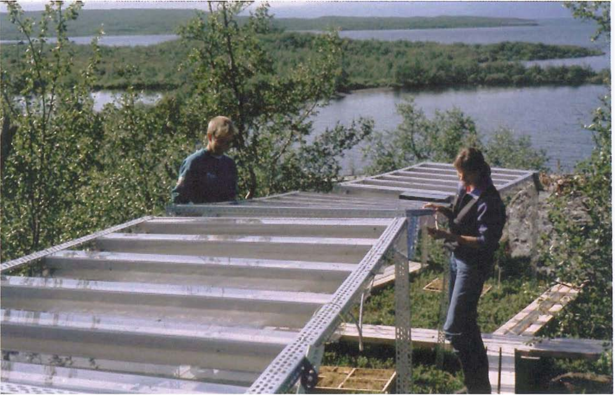
Ulf Johansson och Carola Gehrke kontrollerar en av bestrålningsanläggningarna i Abisko. Verkningar av ytterligare ozonförtunning studeras genom att den naturliga vegetationen utsätts för extra ultraviolett strålning. Långtidseffekterna förväntas vara de viktigaste, och ett av försöken har snart pågått i tio år.
