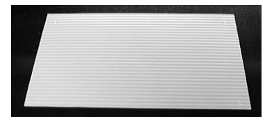
Figur 4. Panel från utflytningsförsök. Bra utflytning ger en jämn yta medan dålig utflytning ger en yta med tydliga linjer efter penseldrag.
