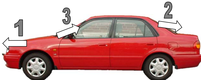
Figur 1. De tre kamerornas placering och riktning på den instrumenterade bilen.
