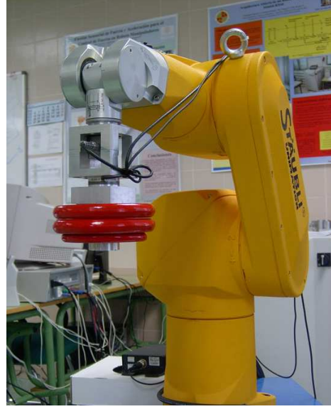
Figura 3: Plataforma Stäubli. Un robot industrial RX60 dotado de arquitectura abierta de control al que se le ha colocado un sensor de fuerza ATI y un acelerómetro en su extremo.
