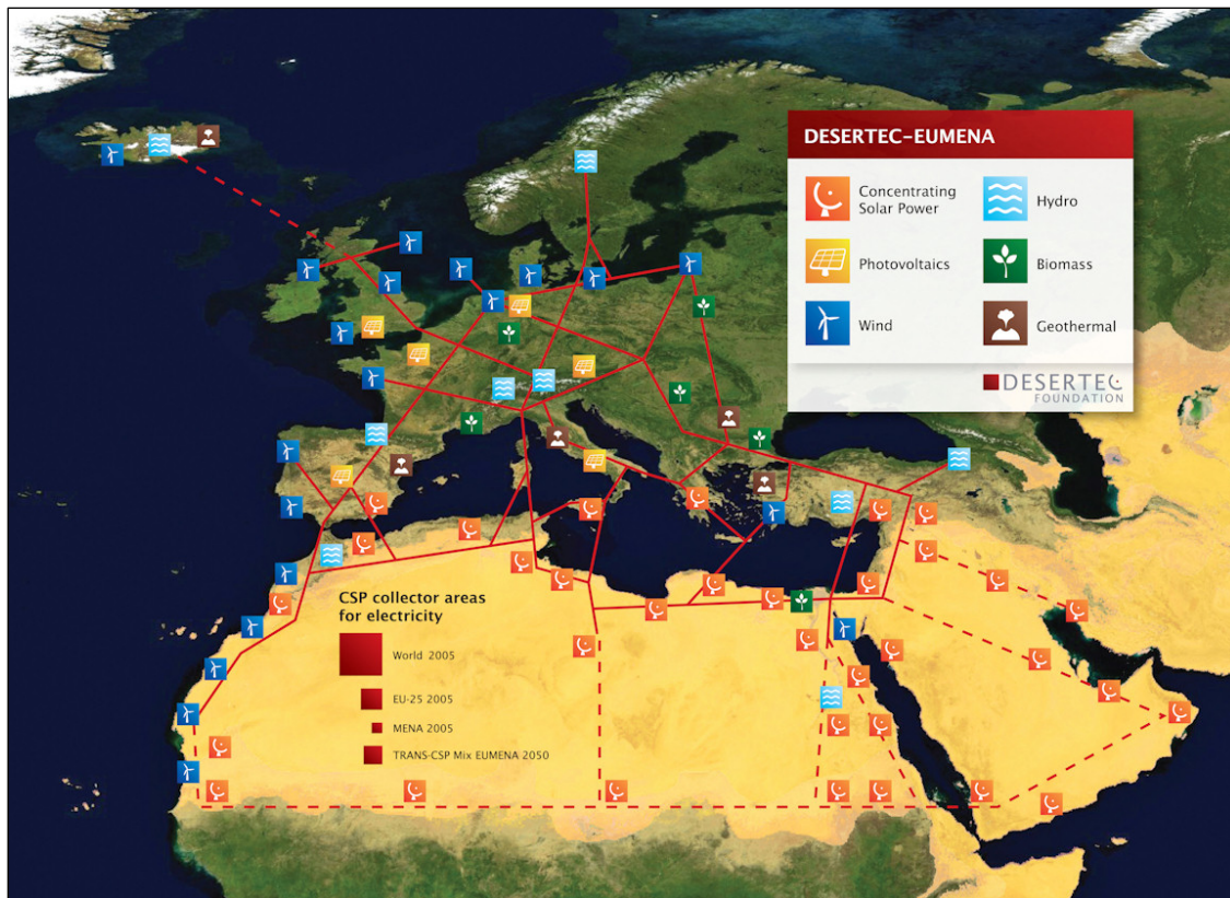
Figur 8 DESERTEC vision med super grids. Bild: Desertec foundation
