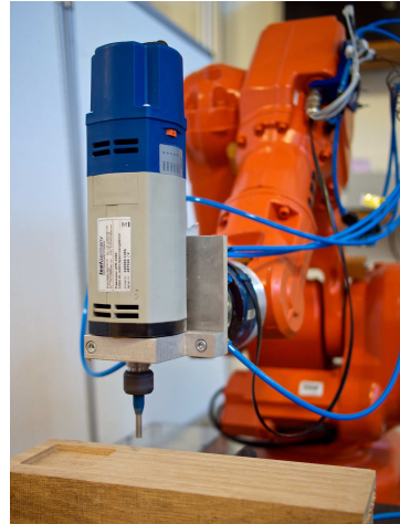
En industrirobot utrustad med fräswerktyg, som använts för experiment i avhandlingen.
