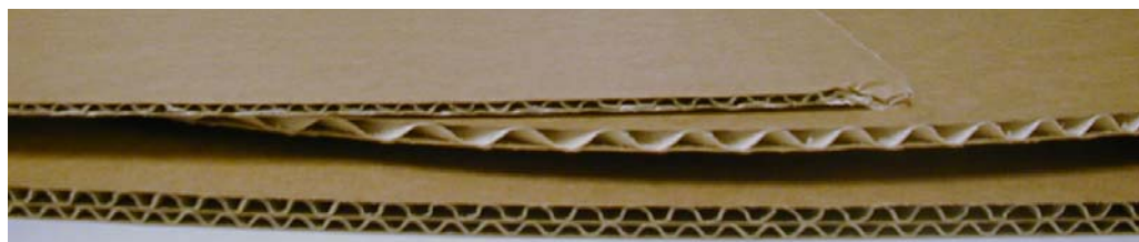
Figur 4-1 - Bild på wellpapp i olika tjocklek och material. Noterbart är bl a skillnaden i flutingtäthet och antal lager av fluting och liner.
