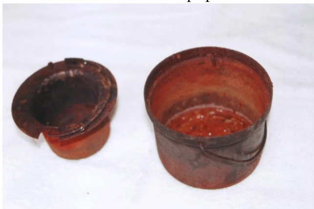
Bild 1: Limpotta. Tagen av författaren 2008-02-10. Lim och vatten läggs i den lilla koppen som sedan sätts i den större koppen vid tillverkning. Den större koppen har också vatten i sig. På så sätt sekundär värmer man satsen och minimerar risken att den blir bränd.
