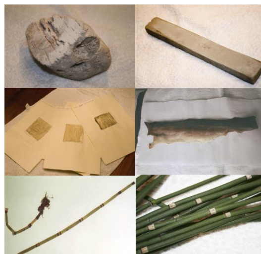
Bild 4: Uppe till vänster) Pimpsten uppe till höger) Sandsten mitten till vänster) Diverse rekonstruktioner mitten till höger) Pigghajsskinn nere till vänster) Gammalt skavgräs nere till höger) Färskt skavgräs. Bilderna tagna av författaren 2008-02-10
