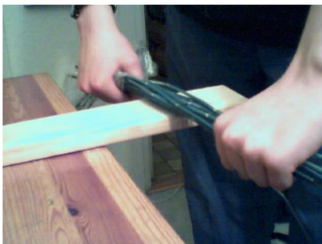
Bild 5: Användning av Skavgräs Bilden tagen av författaren 2008-03-19
