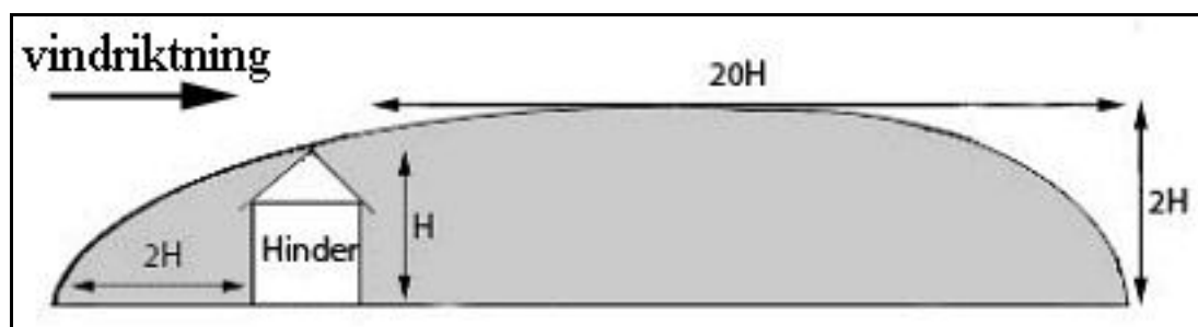
Figur 17: Turbulens från ett hinder med höjden H (i detta fall ett hus). Det grå området representerar stark turbulens. (Wizelius 2007, sid 62)
