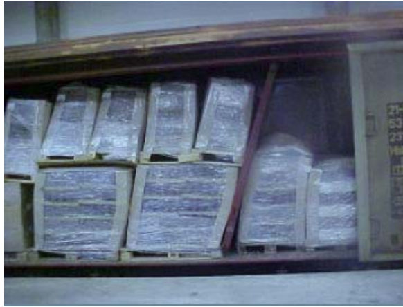
Figur 5.9: Skiljeväggar saknar i regel fästpunkter upptill vilket ger upphov till följande scenario. (Vinnova)
