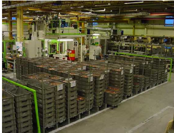
Bild 3.1 Flat Storage vid pressmaskinerna
