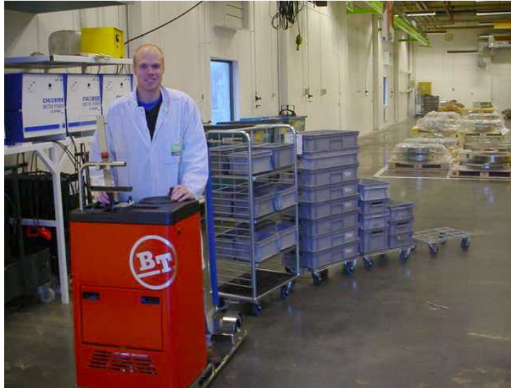
Bild 1.1 Linefeedertåg med linefeederlok och small boxes lastade på en vagn och rollers
