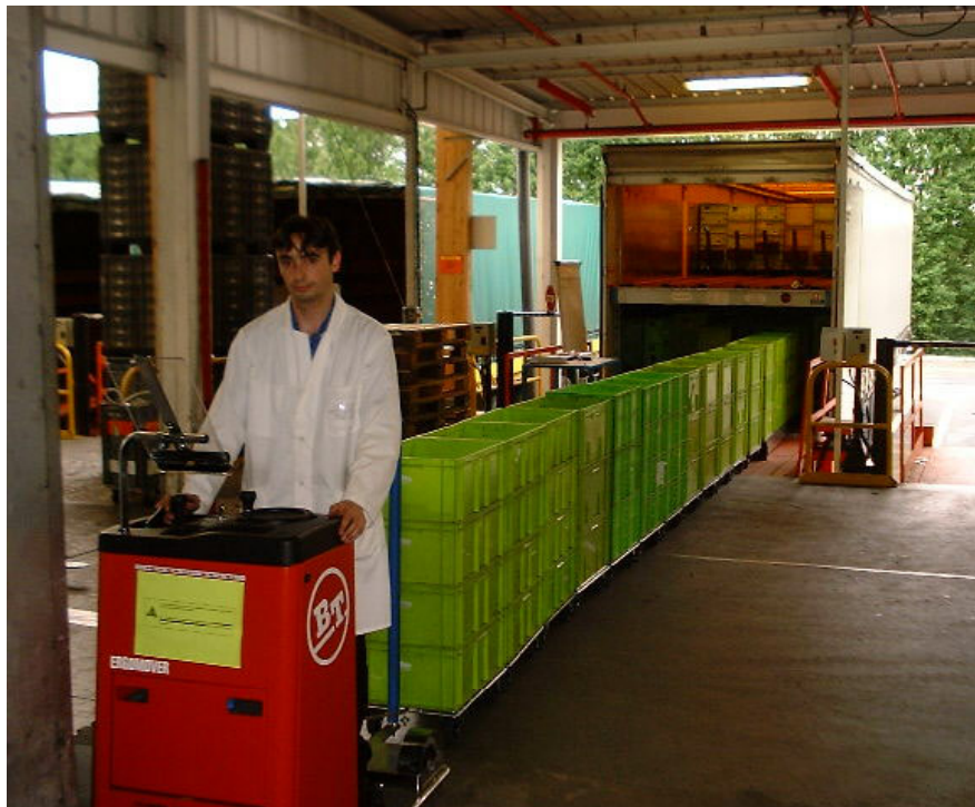
Bild 3.5 Lossning av small boxes som levererats från underleverantörer till en annan valeofabrik. Om underleverantörerna levererar direkt i small boxes undviks omlastningsarbetet i centrallagret
