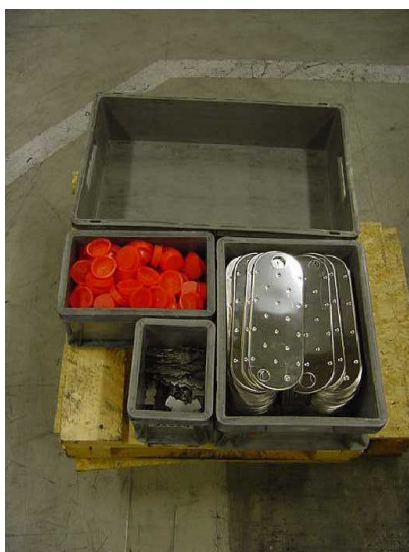
Bild 2.1 Olika small box storlekar. Boxarnas storlek är en jämn andel av en standard EUR-pall
