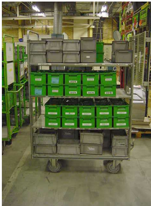
Bild 3.4 Vagn lastad med olika delkomponenter till ett monteringsställe
