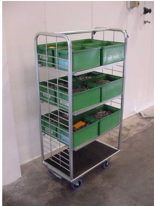
Bild 4.1 Vårt förslag på lagring av högfrekventa artiklar i centrallagret. Denna vagn minskar antalet manuella lyft och är billigare, flexiblere än rullfack
