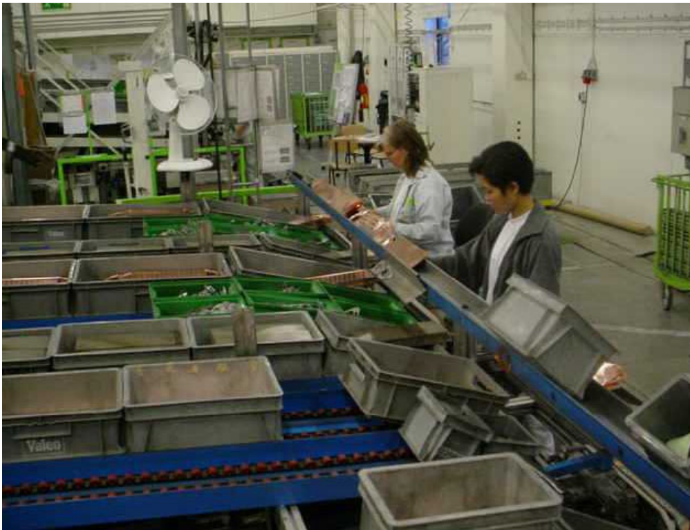
Bild 3.6 Monteringslina med Frontal Feeding av small boxes
