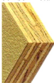
Bild 3-10. Plywood i genomskärning 55
