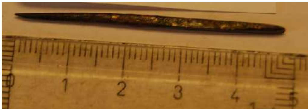
Figur 1: En typisk bronsfyl. Framdelen är spetsigt koniskt rund och övergår på ungefär mitten till en bakdel som är fyrkantigt konisk och på änden tillplattad.
