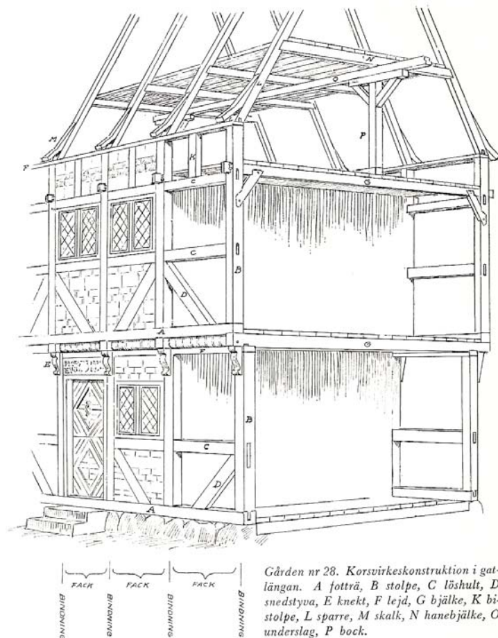
Fig. 3. Korsvirkeshuskonstruktion som visar hur fack och bindningar kan ha sett ut på senmedeltiden (Bager 1938:345).
