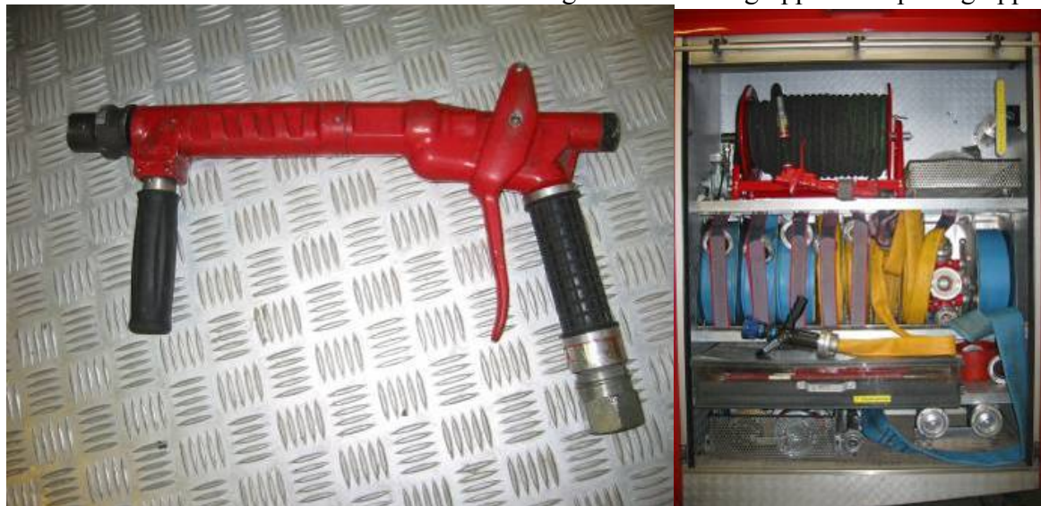
Figur 43. Strålrör som används på Island samt slangskåp.
