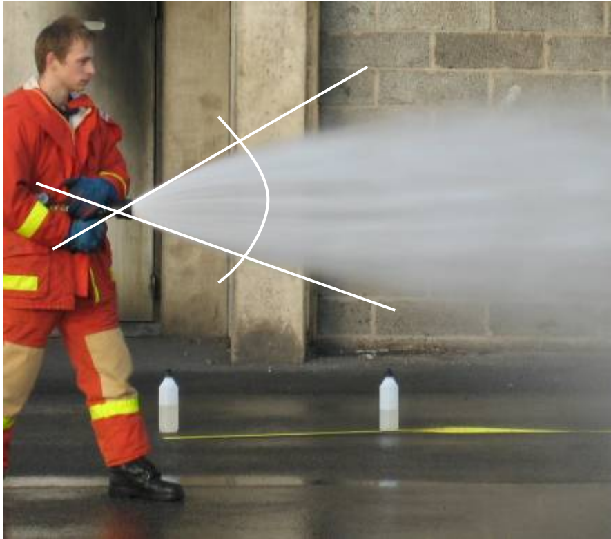
Figur 58. Konvinkeln, 55°, för Akron 1704, 115lpm-läget.
