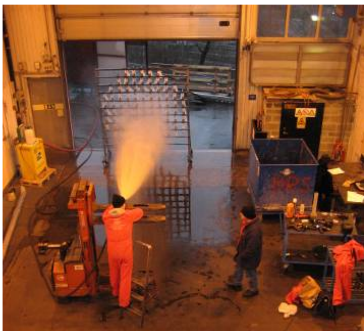
Figur 83. Strålröret i öppet läge riktat mot försöksriggen.
