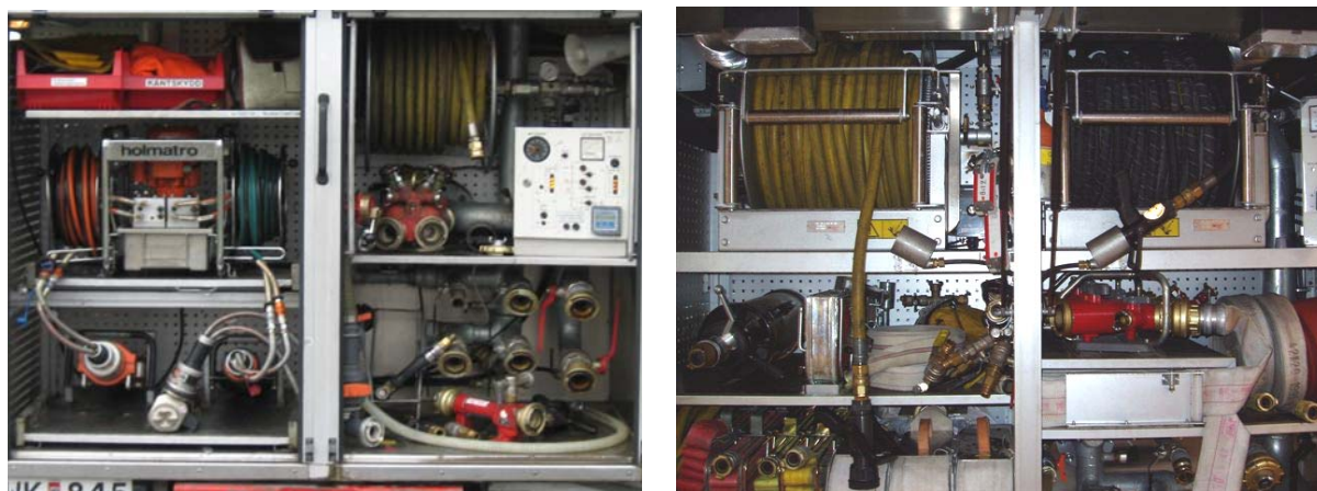
Figur 33. Olika montage av centrumrulle.
