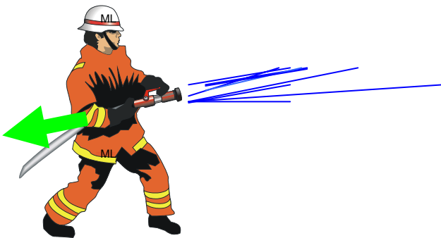
Figur 12. Reaktionskraft vid användande av strålrör.
