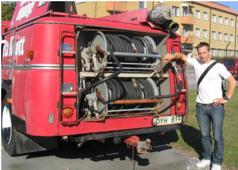
Figur 3. Gamml brandbil (Ford från 1968) med centrumrullad formstabil slang.
