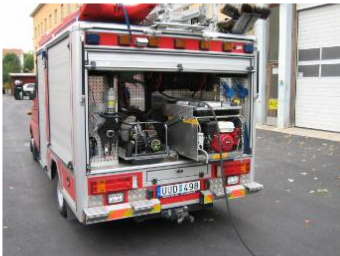
Figur 48. Enhet 303 i på Södertörns brandförsvarsförbund med Fireexpressenhet påbyggd bak.
