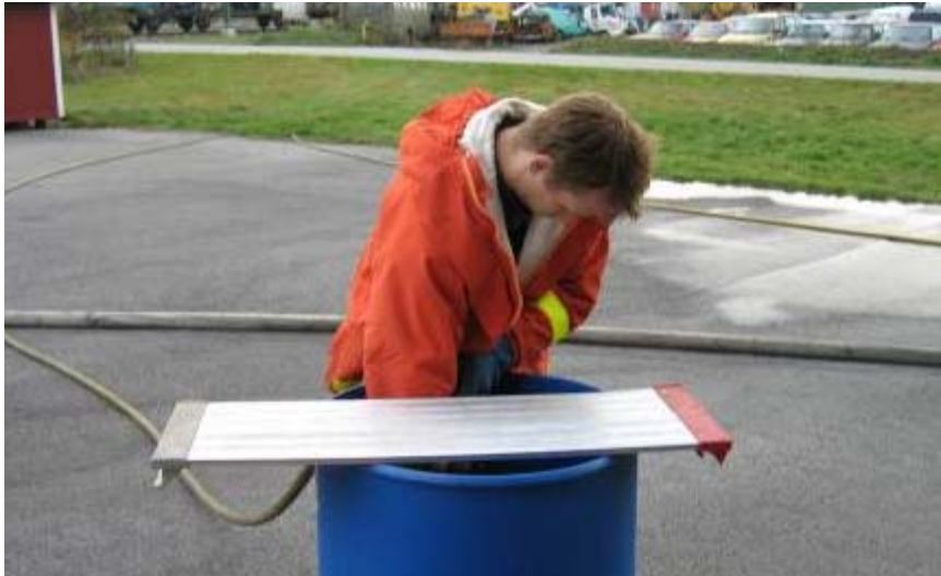
Figur 51. Flödesmätning i 200 liters tunna.
