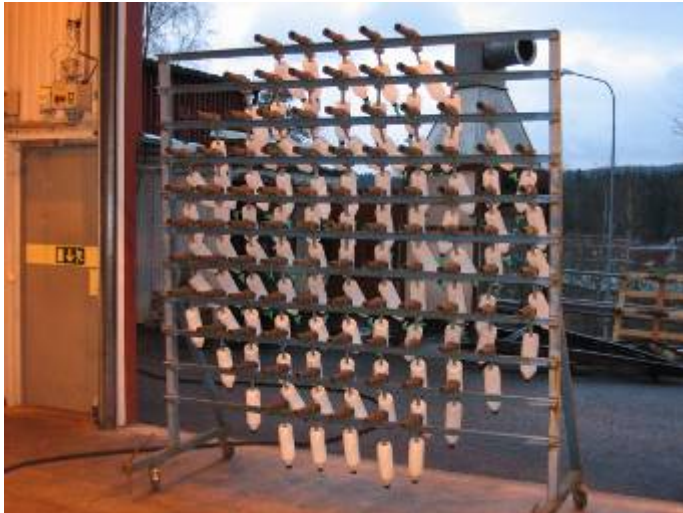
Figur 81. Försöksriggen med 97 uppsamlingsrör och flaskor.
