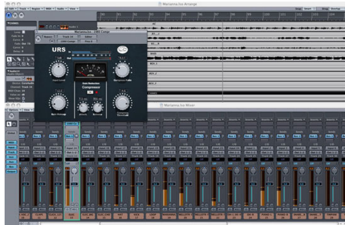
Bild 5: Även här bild tagen från Logic. Här ser vi hur en plug-in, en i detta fall kompressor, har öppnats upp för att tillämpas på en viss kanal i "sessionet".
