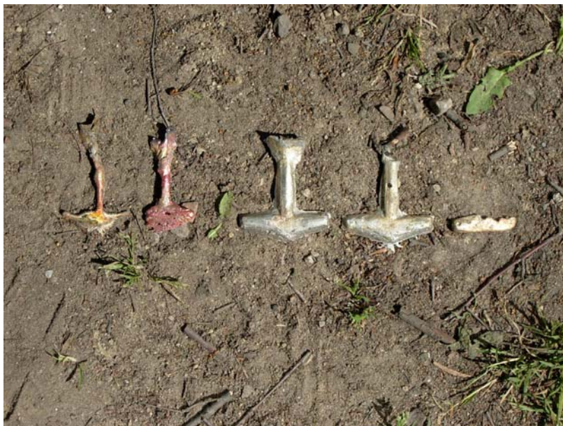
FIG 22 Tre misslyckade och två lyckade gjutningar gjorda på mindre än en timme.
