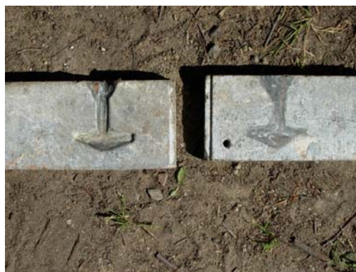
FIG 12 Den färdiga stenformen gjord med kniv och stämjärn.
