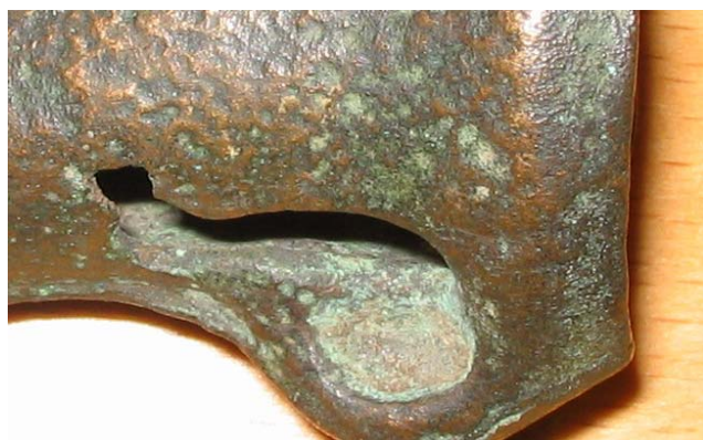
Fig 29 Gjutfel på en holkyxa. LHUM 14083
