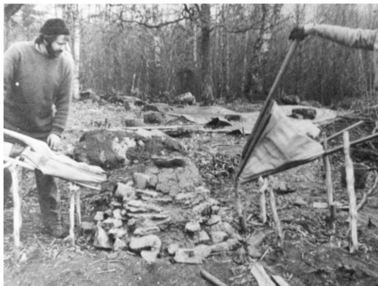
FIG 5 Försök med att tillverka koppar ur svensk kopparmalm.
