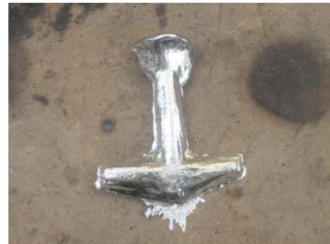
FIG 42 Tenngjutning med spår efter stenformen.
