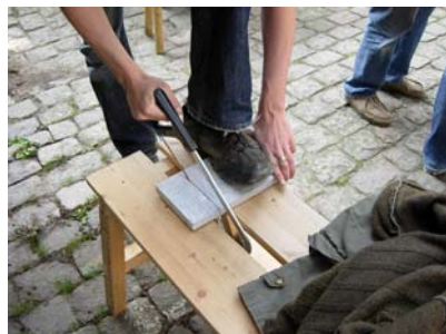
FIG 11 Utsågning av formen med bågfyl.
