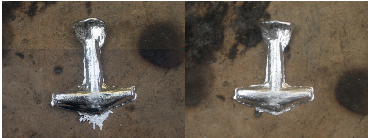
FIG 21 Den första gjutningen i tenn till vänster och den sista till höger.
