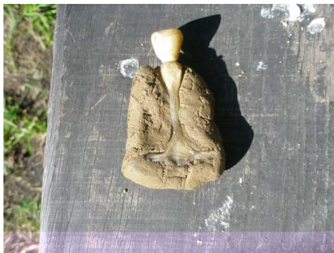
FIG 24 En till hälften färdig lerform med förlorad vaxteknik.
