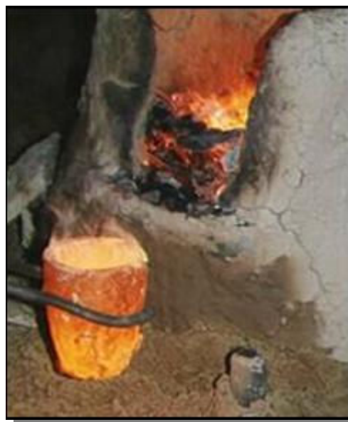
Bild 7. Bronsgjutning (degel och härd).
