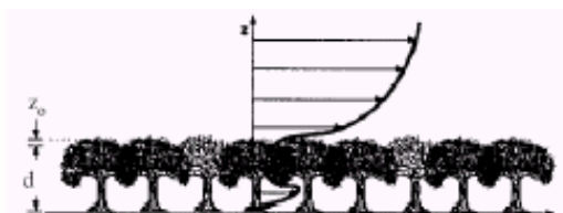
Figur 9. En schematisk bild över hur vindprofilen kan se ut över en lövskog. Beteckningen d visar nollplansförskjutningen och z_0 är råhetslängden. (van Lieshout 2004)
