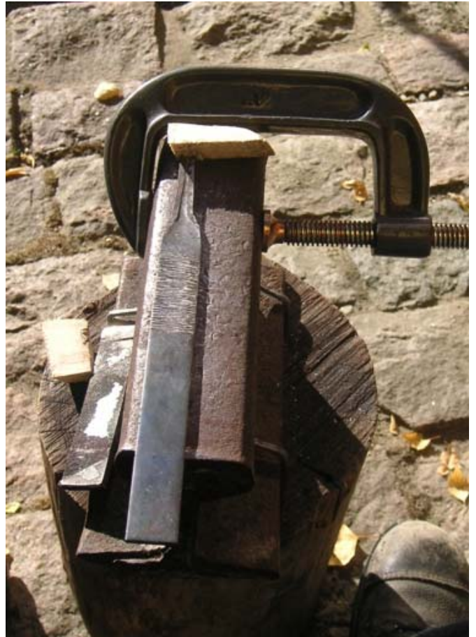
Arbetsplattformen – en G-ting på en bit järnvägsräls
