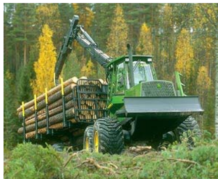
Figur 13. Skotare samlar upp den stock som skördaren lämnat efter sig. Hämtad: http://www.deere.com/sv_SE/forestry/forestry_equipment/forwarders/machines/1710d.html
