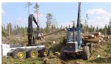
Figur 14 och 15. Besten är en fjärrstyrd maskin vilket gör att den saknar förarhytt. Hämtad på: http://www.sveaskog.se/templates/PageExt___12842.aspx
