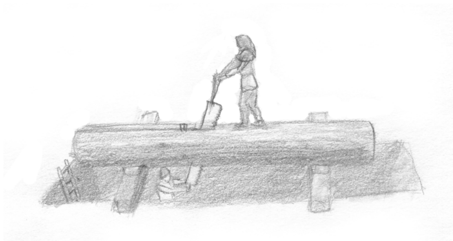
Fig. 7 Klyvsågning med kransåg i såggrop.
