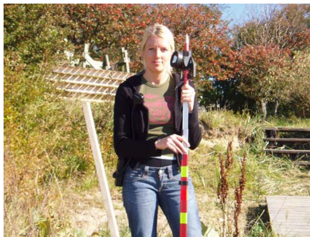
Figur 5.1. Det prisma, som användes i roddbåten för mätning i x-, y- och z-led.
