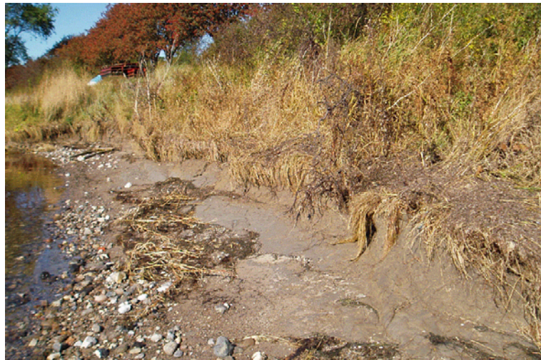
Figur 3.8. Leran blottas vid vattenlinjen. Det är även möjligt att urskilja de olika kornfraktionerna.
