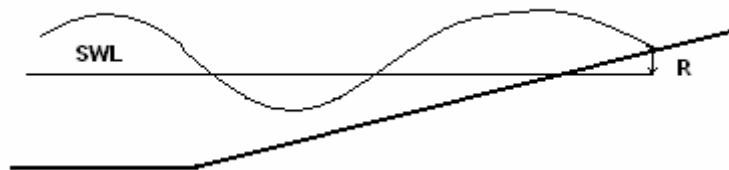
Figur 9.1. Uppspolningshöjden, R . SWL (Still Water Level) står för vattennivån vid lugnt vatten,
