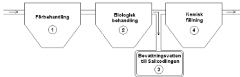
Figur 2. Reningsverkens principiella uppbyggnad. Pilarna visar vattnets flödesriktning.
