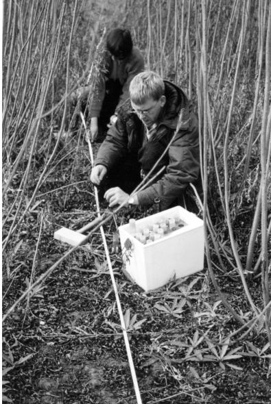
Figur 12. Denitrifikationsmätning i fält.
