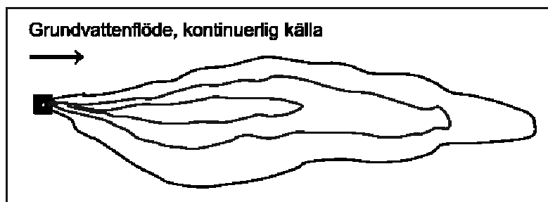
Fig. 7. Spridningen i x- och y-led från en tänkt kontinuerlig källa. (Källa: efter Freeze & Cherry, 1979).
