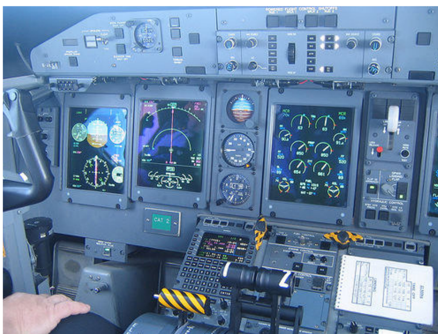
Figur 4. Glas-cockpit. Notera de analoga instrumenten i mitten vilka används som reserv om de digitala instrumenten slutar fungera. (källa: http://flickr.com/photos/rogiernieuwendijk/15442310/ )
