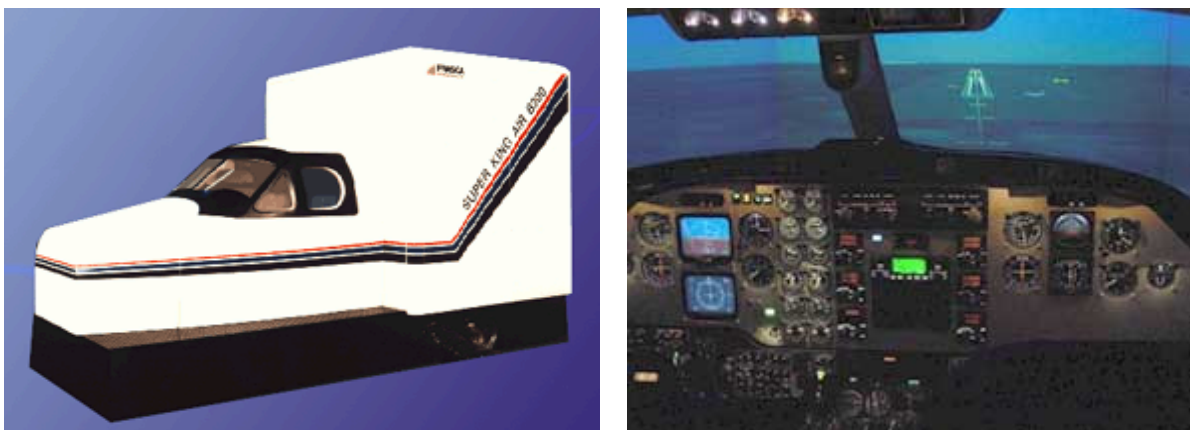
Figur 7. FNPT II MCC exteriör och interiör. (källa: http://www.tfhs.lu.se/utbildning/index.htm ).
