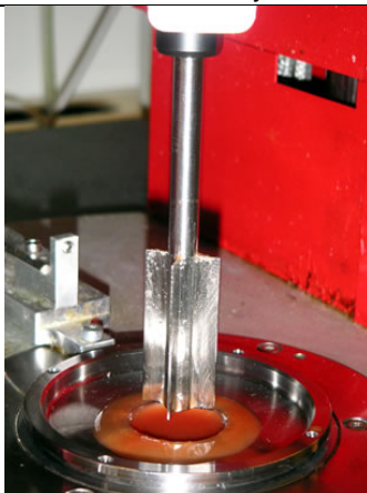
Figur 8-3 På bilden visas den propeller som användes vid försöken för att bestämma yield value.
