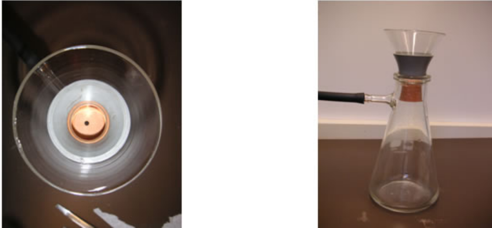
Figur 8-4 På den vänstra bilden visas glastratten med gummikorken i botten ovanifrån innan ketchupen applicerades. På den högra bilden visas tratten med korken på en e-kolv. Genom att koppla slangen till vänster till en vattensug applicerades ett undertryck till e-kolven som gjorde att ketchupen sögs ut på ett motsvarande sätt som om den hade tryckts ut genom en flaska.
