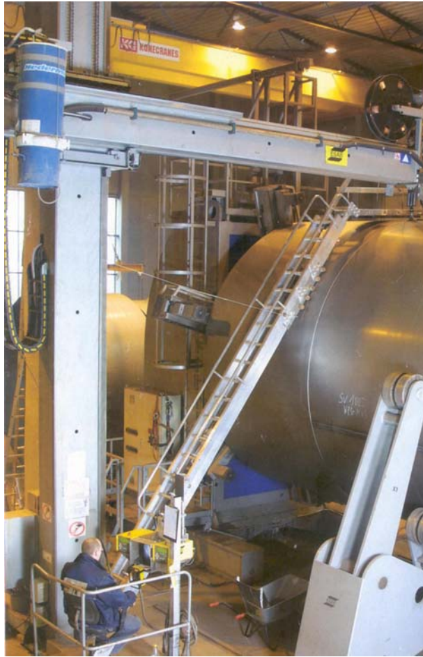
Figur 27 Kameraövervakad pulverbågsvetsning vid DS-SM 168
