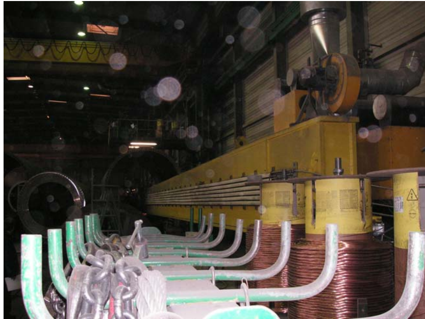
Figur 25 SAM Magdeburgs egenhändigt konstruerad svetskran med en 30 meter lång fast arm med tre pulverbågssvetsaggregat. 163
