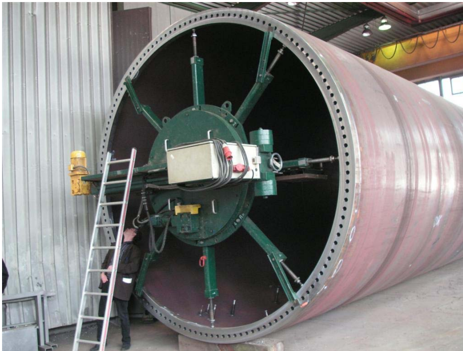
Figur 30 Fräsutrustning för planing av fläns 180
