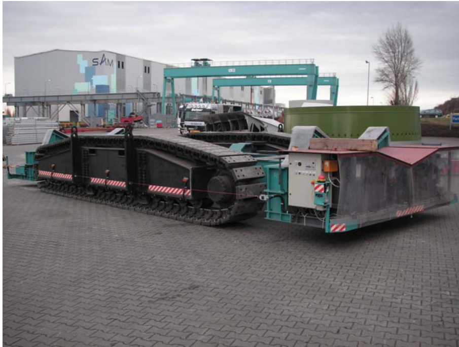
Figur 39 Bandvagn för utomhustransport av tornsektioner. 200
