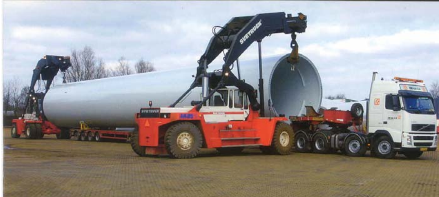
Figur 41 Truckar för hantering av tornsektioner vid DS-SM 203
