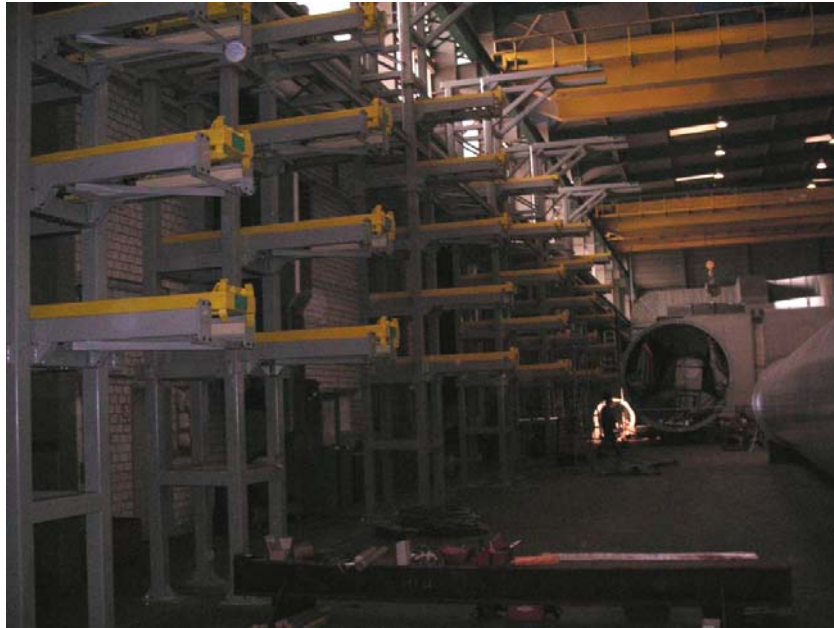
Figur 36 Väggeställning för färdigmonterade stegar och kabelstegar 194
