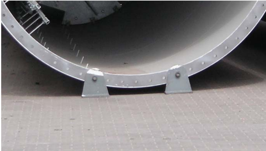
Figur 42 Vid förvaring av tornen använde SIAG Finsterwalde sig av trekantiga fötter som stöd. 205
