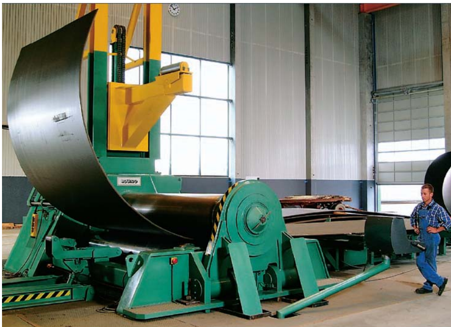
Figur 18 Valsning av plåt till svep 112
