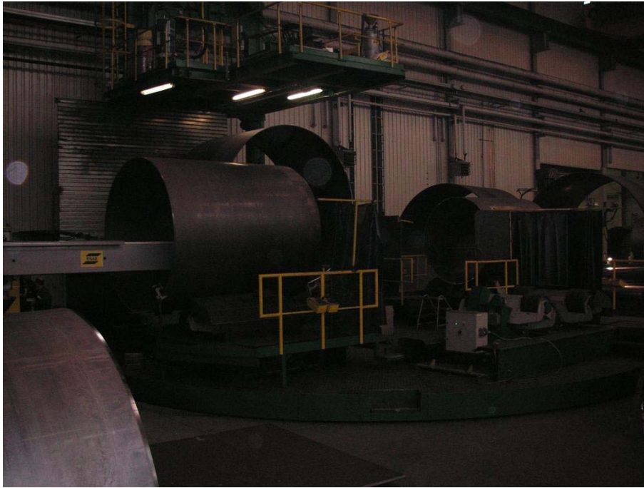
Figur 22 Karusell vid långskarvsvetsning 152
