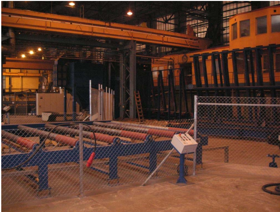
Figur 14 EWP:s stående bläster. Blästern syns längst bak, medan ena rullbordet syns uppfällt till höger. 108
