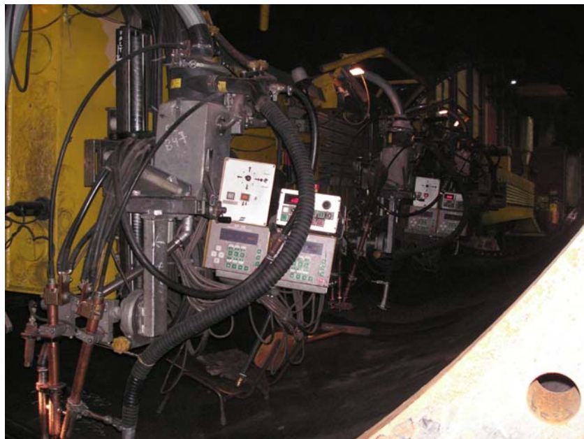
Figur 26 SAM Magdeburgs egenhändigt konstruerad svetskran med en 30 meter lång fast arm med tre pulverbågssvetsaggregat. 164
