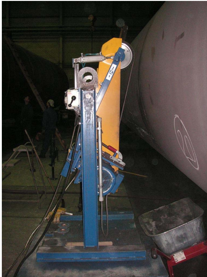
Figur 29 Bandslip för utvärdig slipning av E-82 172
