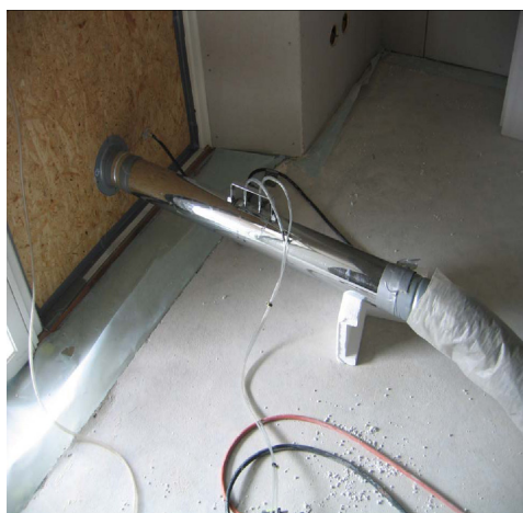
Figur 2.7 Tryckavläsningsrör anger hur stort flöde som krävs för att behålla trycket. 40
