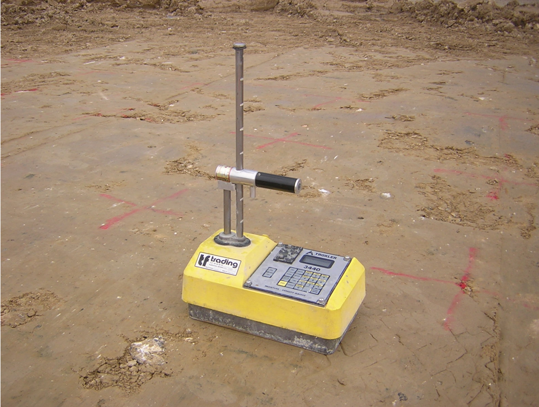
Figur 5.7 Bilden visar en troxlermätning.
