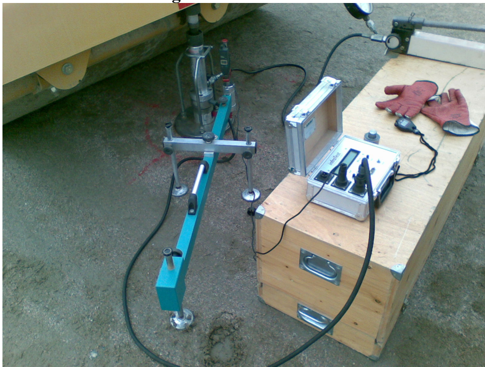
Figur 5.6 Bilden visar ett statiskt plattbelastningsförsök. Bilden är tagen vid ett annat tillfälle.
