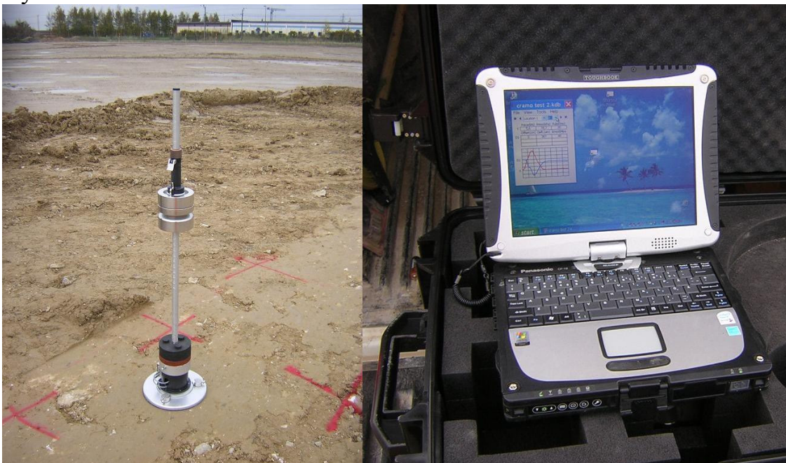
Figur 5.4 Dynatest lätt fallvikt (vänster) och dator med bluetooth (höger)
