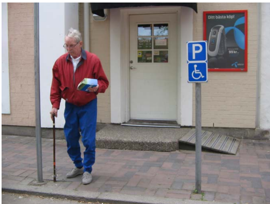
Figur 4.2 Fotografiet ovan visar exempel på hur en verksamhet i Ängelholm enkelt har byggt bort problemet med trappsteg. Fotograferat 2006-05-13
