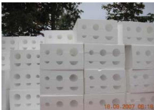
Figur 14. Figurerna visar hur rören ser ut i cellplastblocket och hur öppningen görs för rören. (Fotot hämtat från NCCs broschyr om Skogs Ekeby och ThermiSol broschyr)
