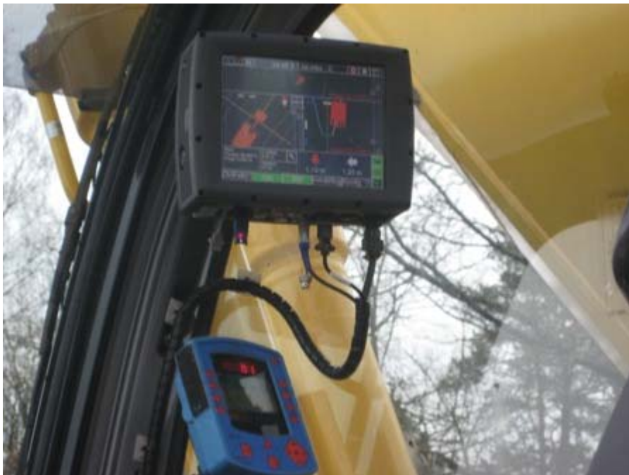
Figur 10. GPS-displayen i grävmaskinen (Bild taget vid Skogs Ekebyprojekt NCC, Stockholm). Foto: Christian Cruz
