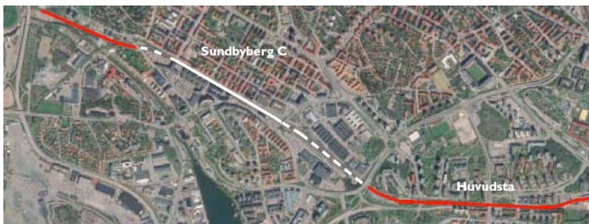
Bild 18. De vitmarkerade linjerna uppvisar den tilltänkta tunneln genom Sundbyberg. De rödmarkerade linjerna uppvisar nedsänkta spår (Banverket, 2006a, s. 52).
