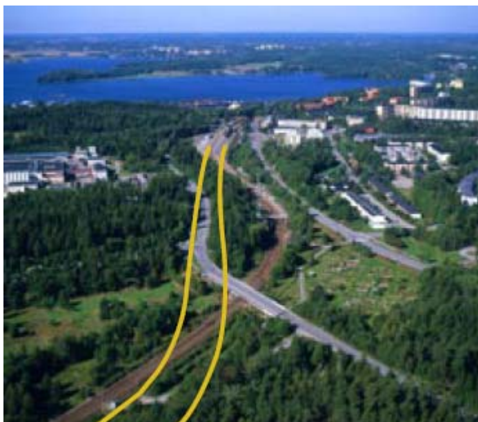
Bild 17. Bilden visar förändring av spårgeometrin av kurvan söder om Kallhälls station. Denna kurvvrättning innebär att Banverket gör intrång i Görvälns naturreservat (Banverket, 2006a, s. 50)
