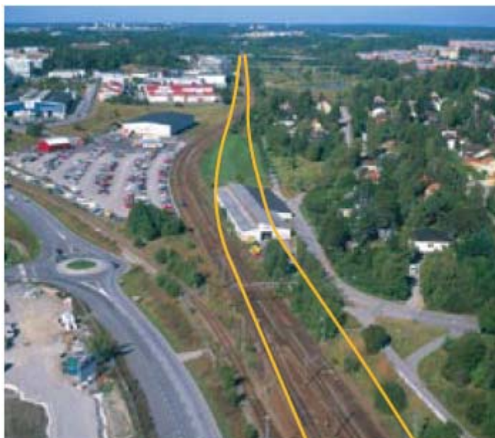
Bild 16. Bilden visar förändring av spårgeometrin av kurvan norr om Spånga station (Banverket, 2006a, s. 50)
