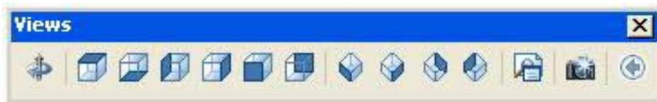
Figur 8. Views , används för att välja från vilket håll du vill se modellen.
