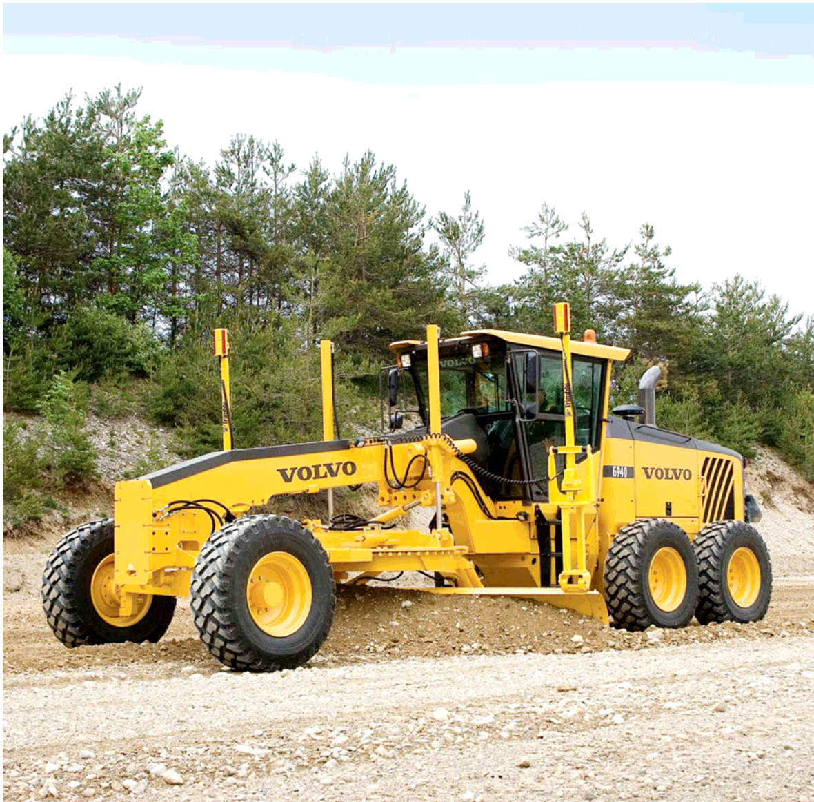
Figur 3. Våghyvel med lasermottagare monterad på bladet. 6
