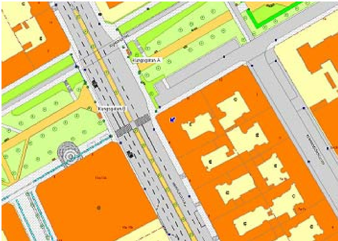
Figur 6.2. Utformning av Kungsgatans busshållplats
