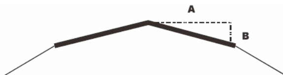
Fig 3.9 Princip för beräkning av tvärfall. (VVMB 115:2004)
