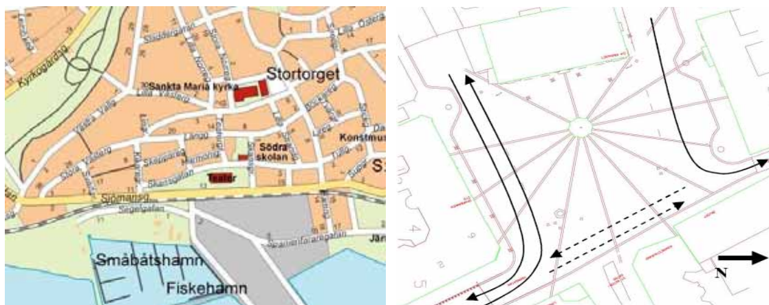
Figur 5.5. Till vänster visas Stortorget i Ystad. (Källa: Lantmäteriet, 2007) Till höger visas körspåren över torgytan, de streckade linjerna gäller endast trafik med särskilt tillstånd.
