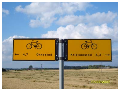
Figur 4.31 skyltar av strängpressat aluminium (Foto: Zainab Mousa)
