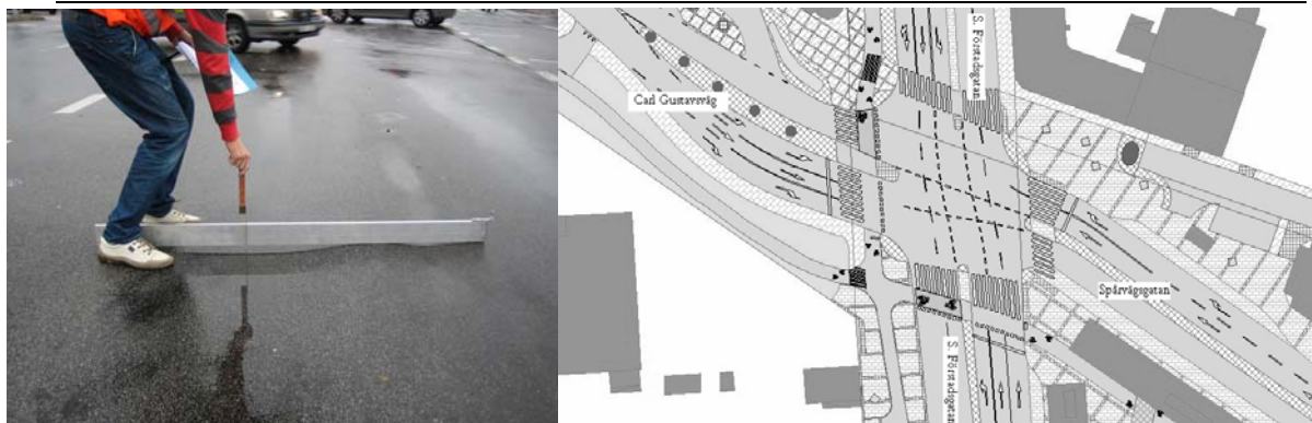
Figur 6.6: TV: Hjulspår på korsningsytan i korsningen Carl Gustavs v/Spårvägsg - S Förstadsg uppvisar spår i korsningsytan (Foto: Mårtensson Wilén).
