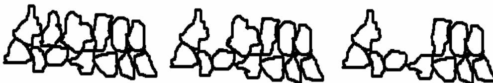
Figur 7.1: Ytan på asfaltens slitlager. Är stenstorleken för stor i ytan så exponeras för stor del av stenen och lossnar lättare när de utsätts för vridbelastning. Blir där ett hål efter en sten ökar belastningen på de stenar som ligger runt hålet. (Mårtensson, Wilén)
