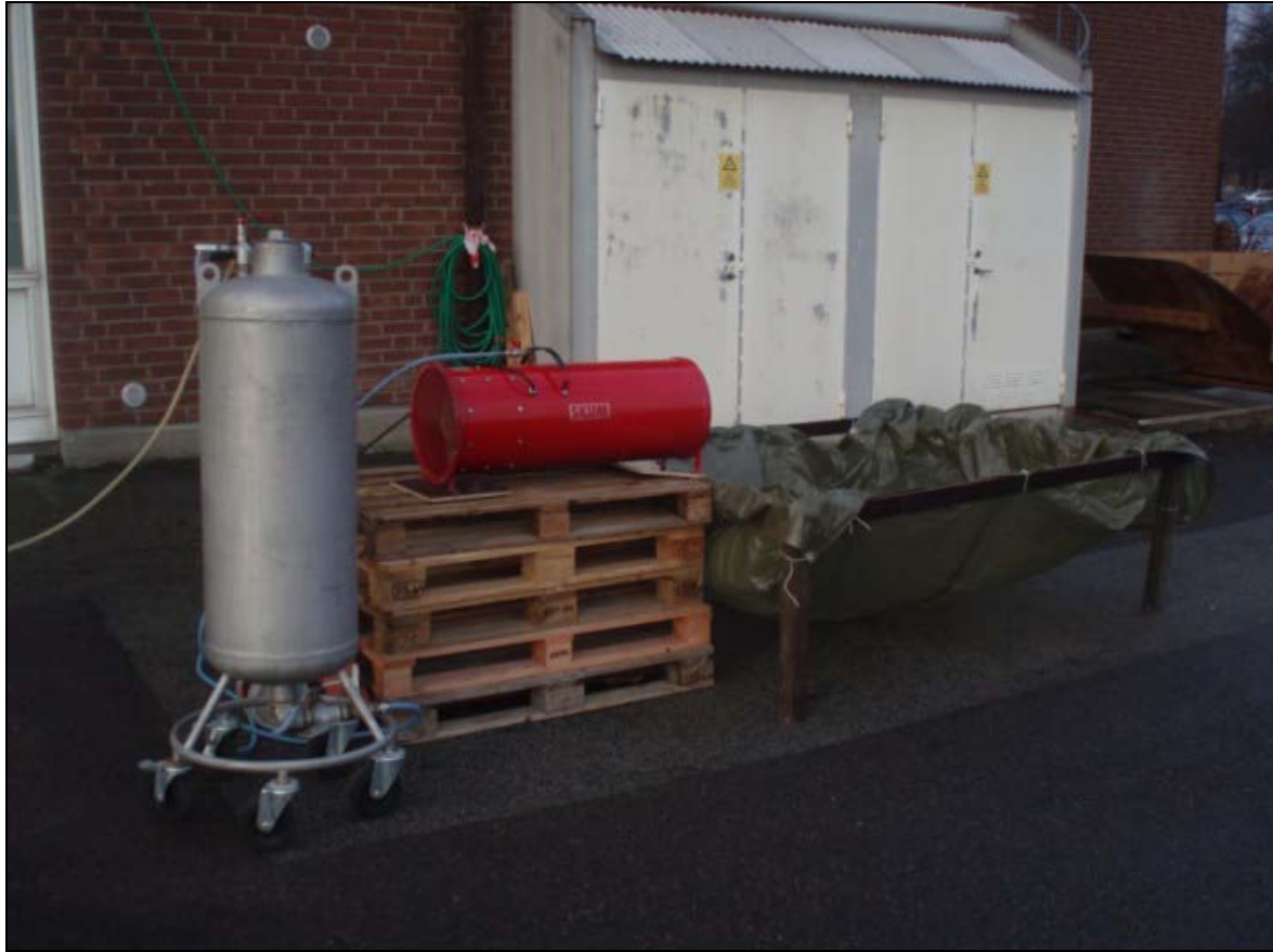
Figur 5.1. Bild på anordning för generering av skum. Till vänster den trycksatta vätsketanken, i mitten skumaggregatet och till höger skumkaret.
