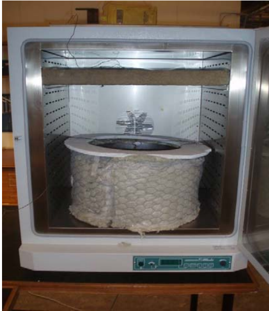
Figur 5.7. Ugnen som användes i försök 3. I ugnen syns det isolerade skumkärlet.
