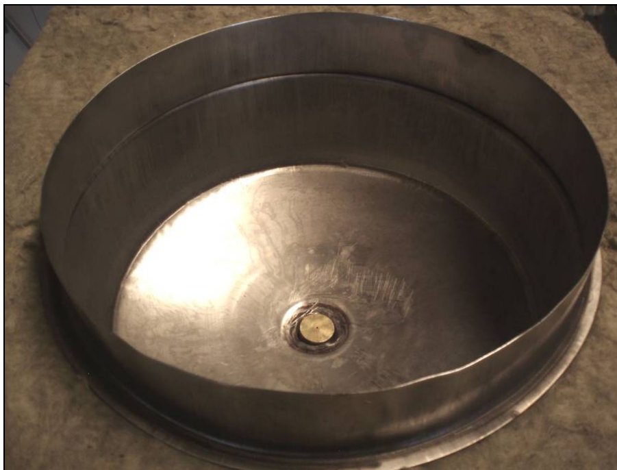
Figur 5.24. Skumkärlet med strålningsmätaren i botten. Observera att locket som används vid försöken ej är med på bilden.
