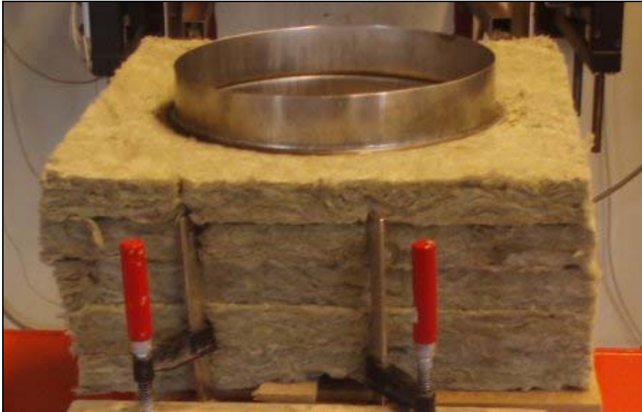
Figur 5.18. Bild på skumkärlet med isolering. Observera att locket som används vid försöken ej är med på bilden.
