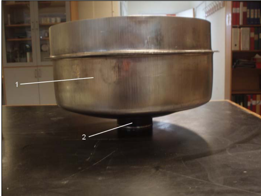
Figur 5.3. Det rostfria skumkärlet (1) som användes vid försöken. Dränerad vätska samlades i det mindre uppsamlingskärlet (2) i botten av det större.
