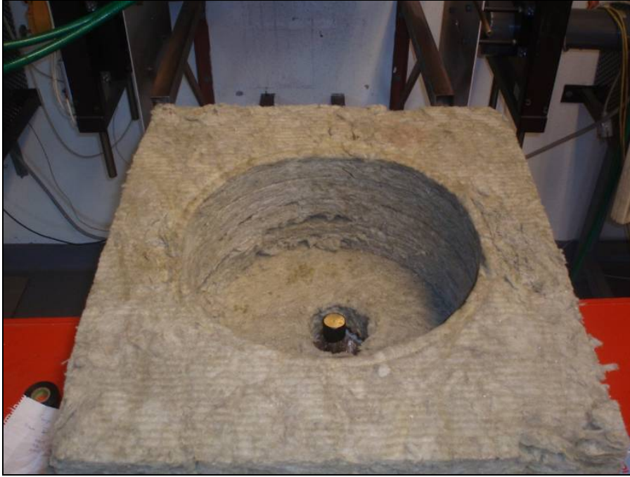
Figur 5.15. Bilden visar strålningsmätaren inför mätning med och utan skyddande plastfolie, jämför med högra figuren i figur 5.14.
