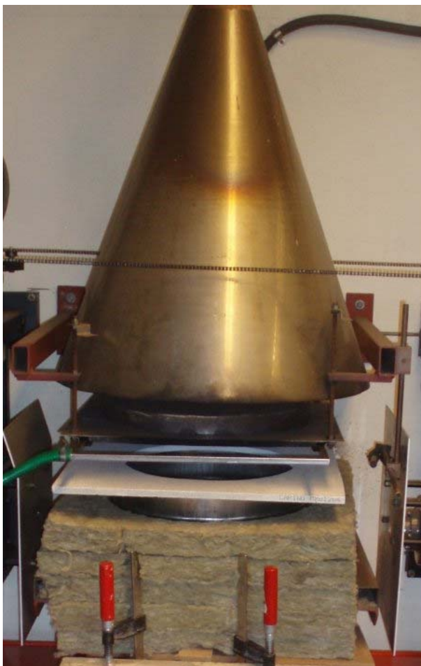
Figur 5.19. Bild och schematisk bild på konen och det isolerade kärlet för försöksupställningen vid mätningförsök 1.
