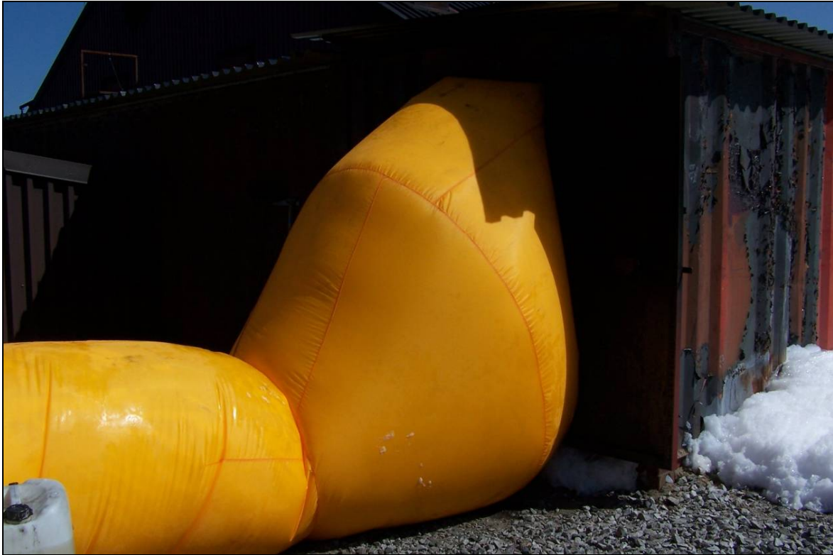
Figur 2.4. För att kunna transportera in lättskummet i en byggnad används en adapter. Foto: Erik Nerhagen.
