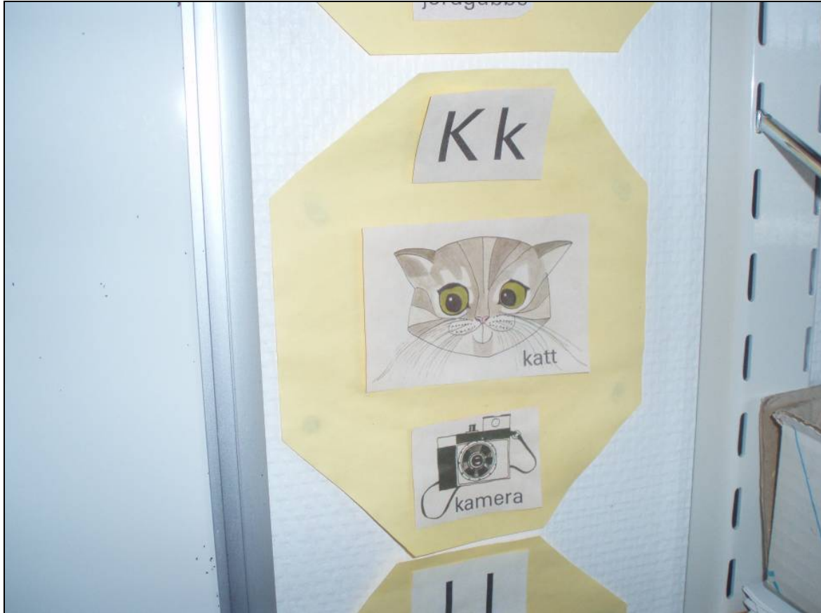
Figur 3.1. Denna plansch, gjord av vanligt papper, har varit utsatt för lättskum i ungefär ett dygn. Planschen var något bucklig av fuktpåverkan men i övrigt oförstörd.
