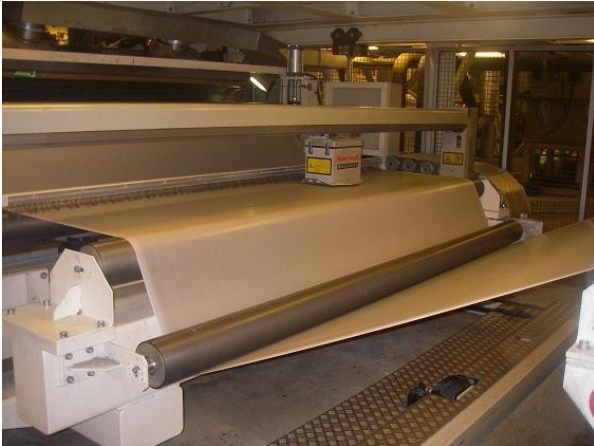
Figur 4: A - planextruderad plastfilm under förflyttning i valsverk, B - utsidan på en skruv som smälter granulat.
