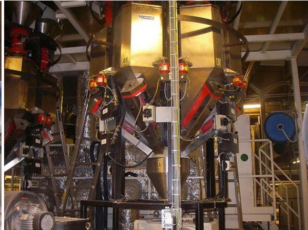
Figur 12: Bild A visar hur vakuumpumpar suger fast plastpåsar i påsavdelningen. B visar granulatfördelare i planextruderingen.
