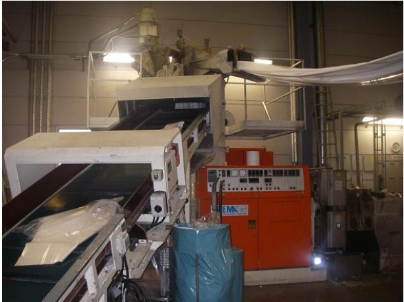
Figur 8: A - spillmaterial förs till regranuleringsenheten på ett rullband, B - spillmaterial rullas av direkt ifrån trissor.
