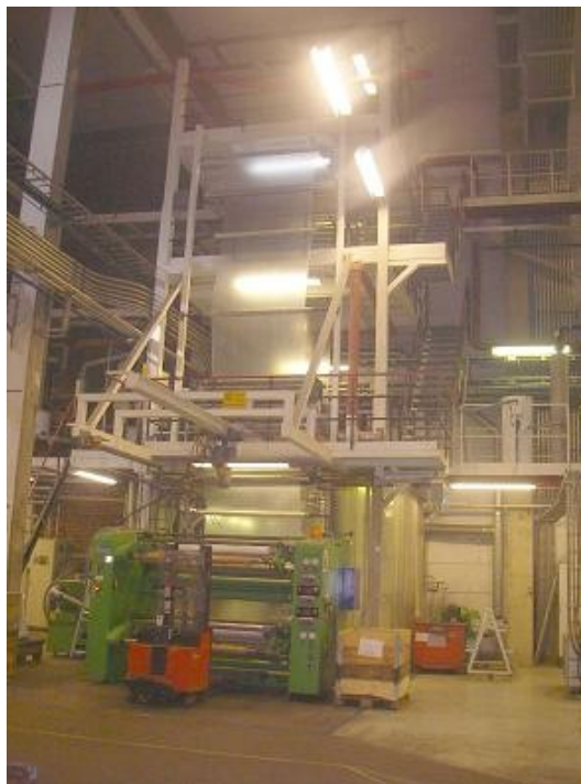
Figur 2: Blåsextruderad plastfilm under luftkylning är på väg att rullas upp på trissor nere vid golvet.
