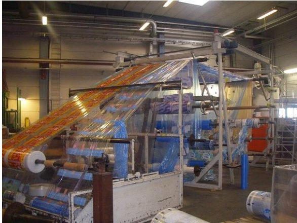
Figur 8: A - spillmaterial förs till regranuleringsenheten på ett rullband, B - spillmaterial rullas av direkt ifrån trissor.
