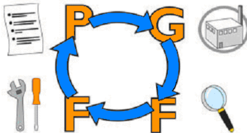
Figur 5. Energiledningsprocessen är uppbyggd enligt en cyklisk process med stegen Planera, Genomföra, Följa upp och Förbättra. Processen innebär att företaget måste uppdatera och förbättra sitt energiarbete kontinuerligt. [61]
