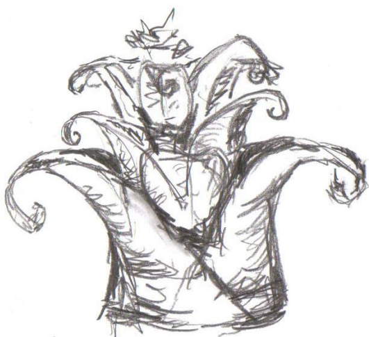
Figur 11. Förslag på kapitäl bestående av ett flertal tunna plåtskivor, böjda och skurna till formen av akantusblad.
