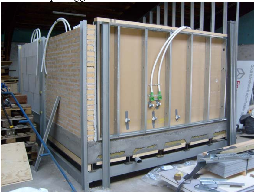
Figur 15. Sensorernas placering i en reglad vägg
